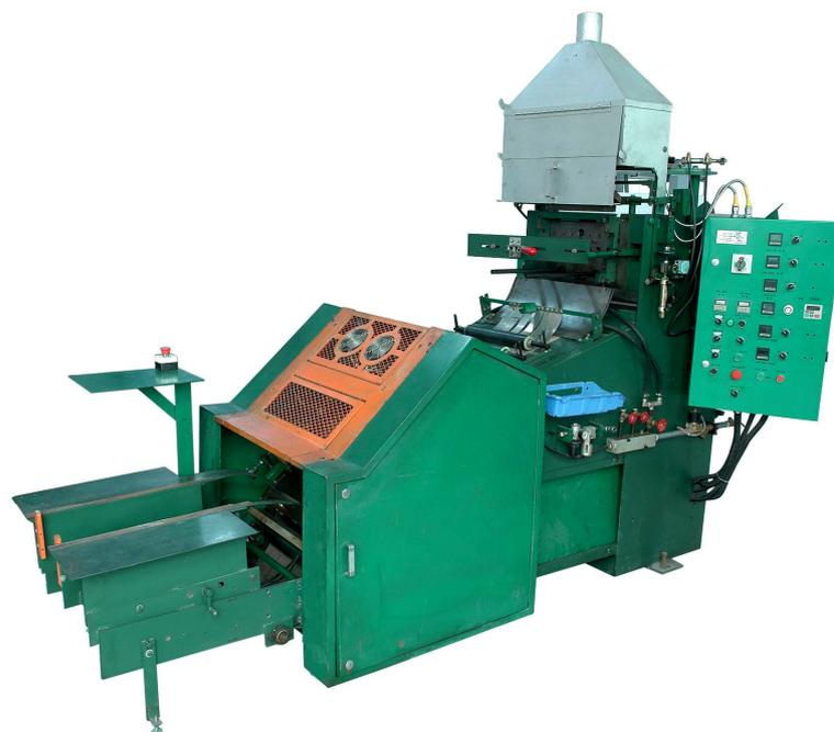
обеспечивают подачу чистого воздуха без примесей масла и воду для матрицы и для форсунок. Индивидуальные воздушные цилиндры предусмотрены для открытия/закрытия и для выталкивания решетки. Клапан для свинца и устройство распределения свинца имеют подачу газа для снижения шлака. Упрощенная отливка решетки замедляет движение системы для снижения искривления решеток. Максимальная толщина отлитой решетки 150 (3.9mm) x 158.75mm формы ширина x 385.75mm от ушка к ушку.
