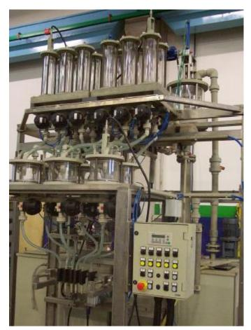
Общая характеристика GEL2: Опорная конструкция реализуется полностью из нержавеющей стали AISI 316L INOX.
