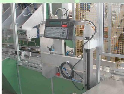
На борту машины установлена алюминиевая рама для крепления устройства маркировки.
