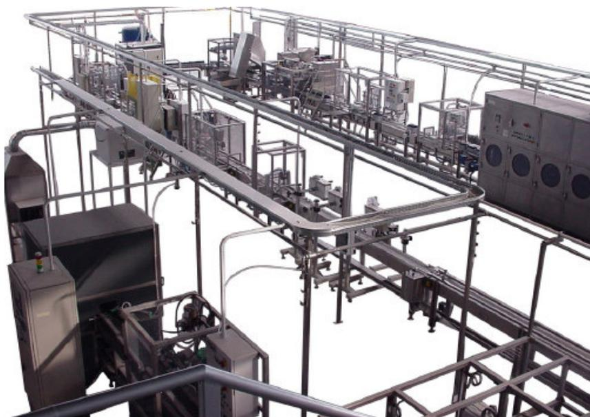
После зарядки батареи подаются на финишную обработку. Они должны быть проверены перед отправкой на рынок. Финишная линия в комплекте производится по запросу клиента либо могут быть установлены отдельные машины на существующих линиях.
