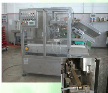
Эта машина устанавливает пластиковые колпачки на полюса для их предохранения. Колпачки имеют 2 цвета: красный для положительных и синие для отрицательных полюсов для простого определения полярности.
