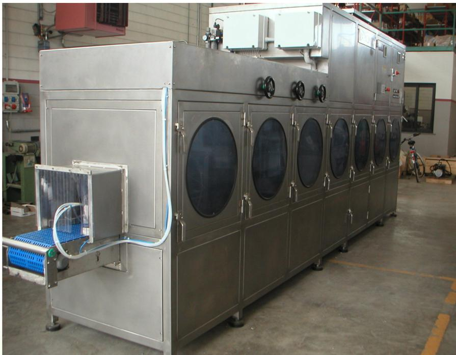
Туннель мойки обрабатывает 8 батарей в минуту, как для легковых, так и для грузовых автомобилей. Регулировка – простая и быстрая.
