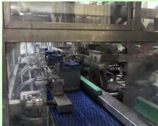
Только на двух отвертках установки крышек для батарей для легковых автомобилей перед циркулярным вибратором предусмотрен магазин для крышек для подачи на циркулярный селектор по конвейеру при необходимости.
