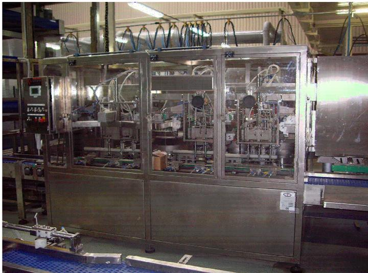
Машина предназначена для установки и закручивания крышек батареи. Обычно машина устанавливается перед туннелем мойки и сушки.
